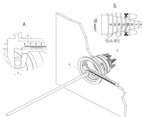
i) С внутренней стороны вставьте фланец (кольцо) и затяните гайки.
