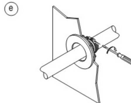
g) Вставьте кабель. (рис А). Затяните хомутом, что бы получить герметичное уплотнение между кабелем и гермовводом.
