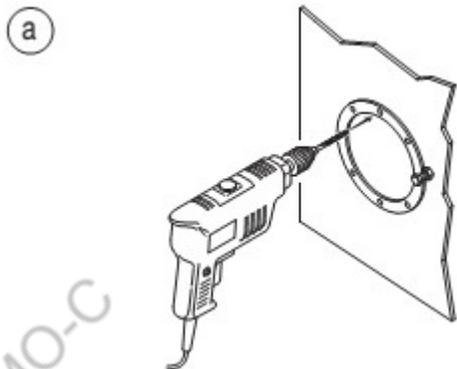
б). Определите местонахождение центра входа трубы, отметив линии, которые сочетают в себе диаметрально противоположные отверстия. Просверлите (пробурите) входное отверстие для прохода трубы.
