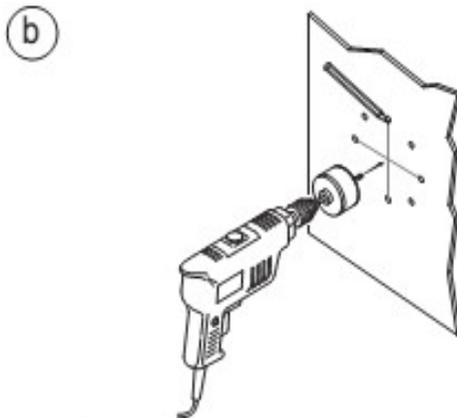
с). Установите гермоввод с внешней стороны скважины. Вставьте винты в соответствующие отверстия.
