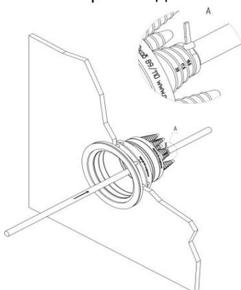
h) Штангенциркулем измерьте диаметр кабеля(рис А). Ножницами обрежьте необходимый диаметр. (рис Б).
